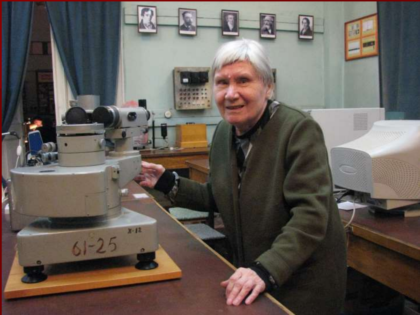
Інженер 1 категорії Агафонова Н.П. готує гоніометр-спектрометр ГС-5 до проведення лабораторних робіт на практикумі з оптики.
