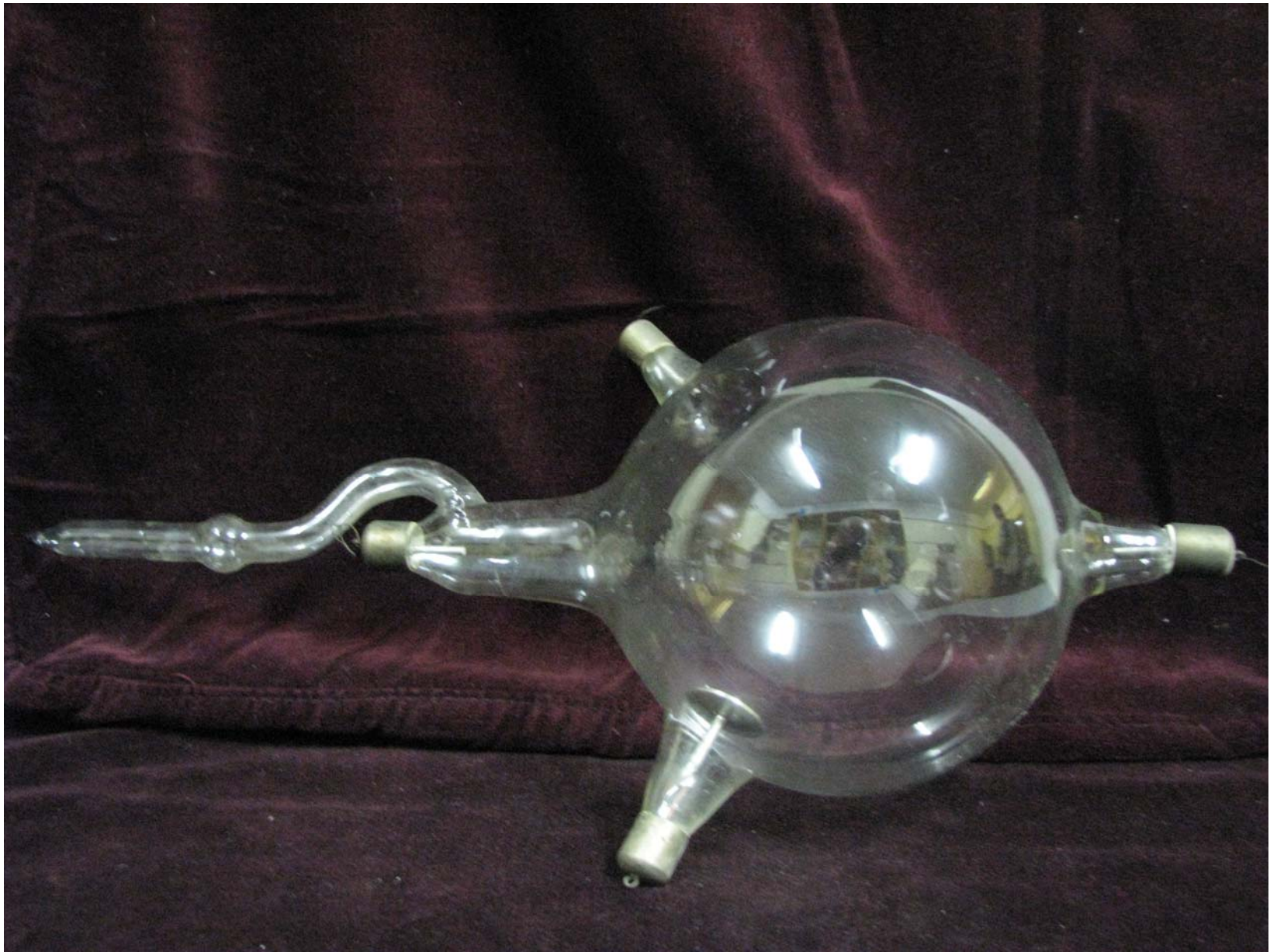
Рентгенівська трубка. Кінець XIX – початок XX століття.
