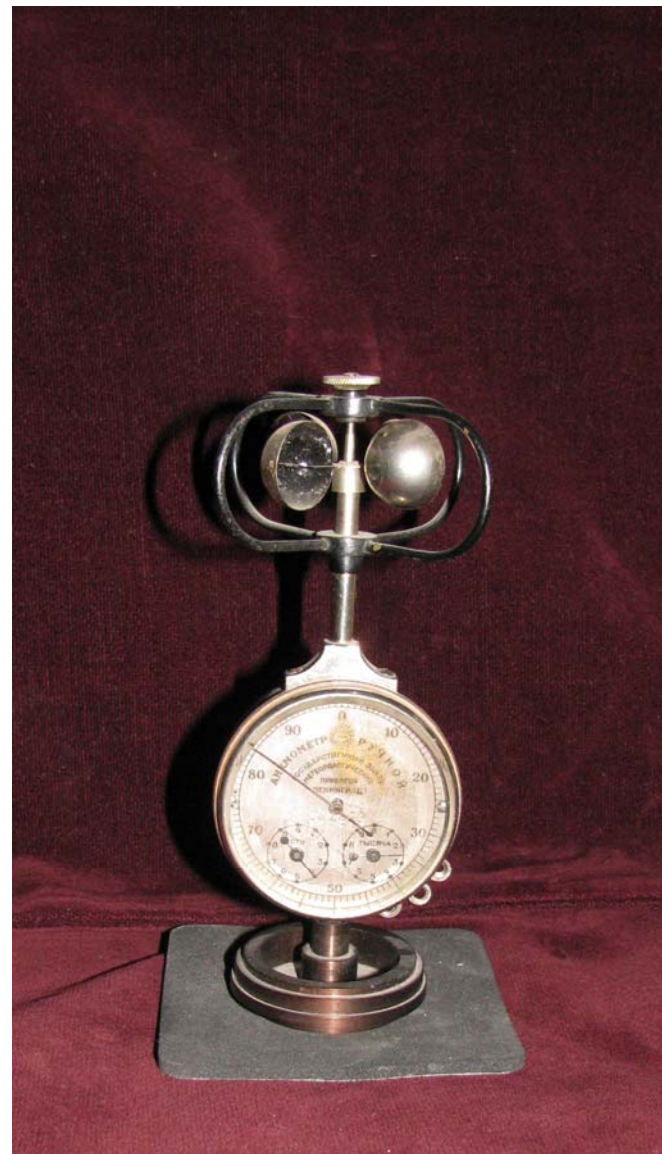
Метеорологічні прилади для вимірювання напрямку та швидкості вітру з колекції фізичного кабінету Харківського університету.
