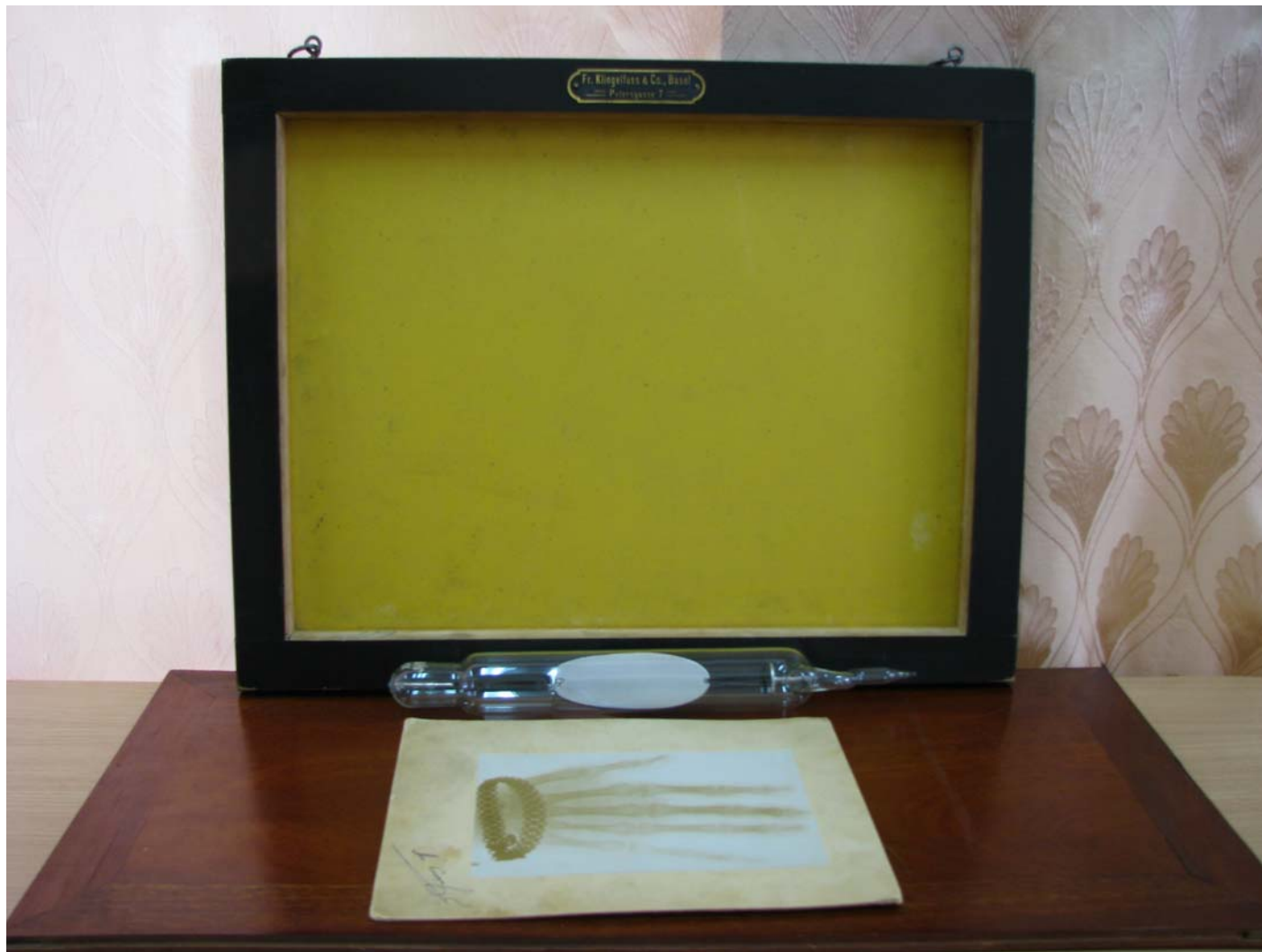
Екран для підсилення фотографічної дії рентгенівських променів, лампа Пулюя та рентгенівський фотознімок жіночої руки з колекції фізичного кабінету Харківського університету. Кінець XIX – початок XX століття.
