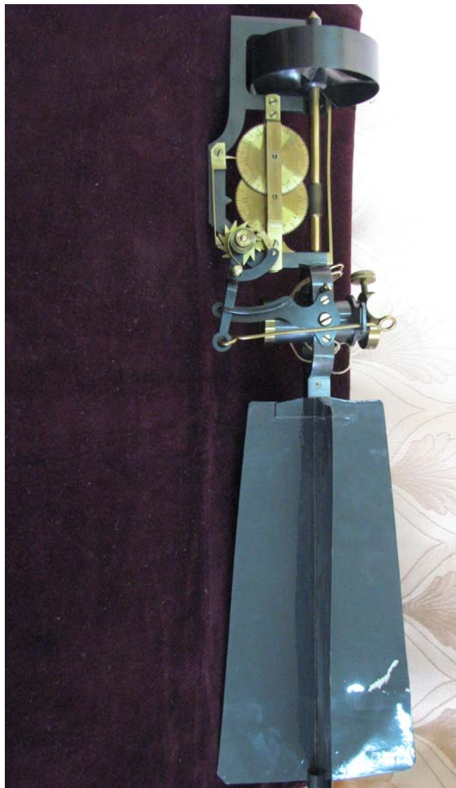
Метеорологічні прилади для вимірювання напрямку та швидкості вітру з колекції фізичного кабінету Харківського університету.
