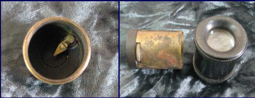
Спінтарископ Крукса, яким, вірогідно, користувався О.П. Грузинцев.
