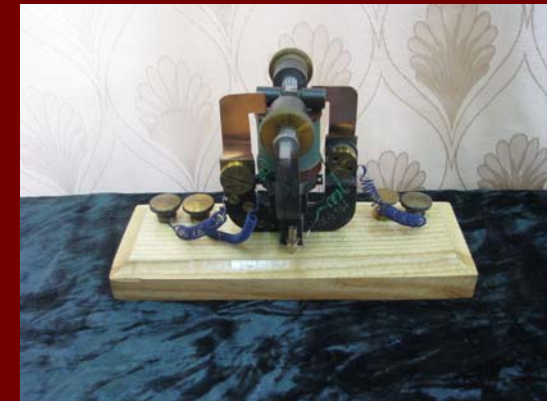
Резонансне реле М.Д. Пильчикова.
