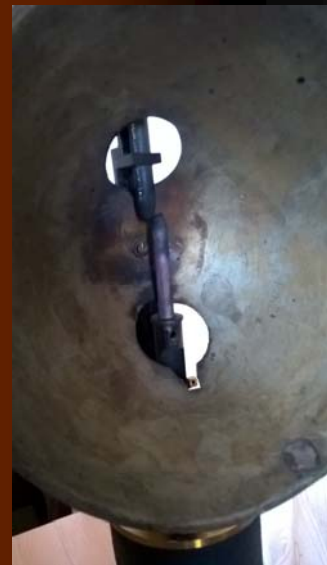
Настільна дугова лампа з автоматичним регулюванням відстаней між електродами з використанням електромагнітів.
