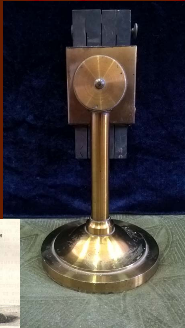
Термостовпчки італійського фізика Мачедоніо Меллоні.
