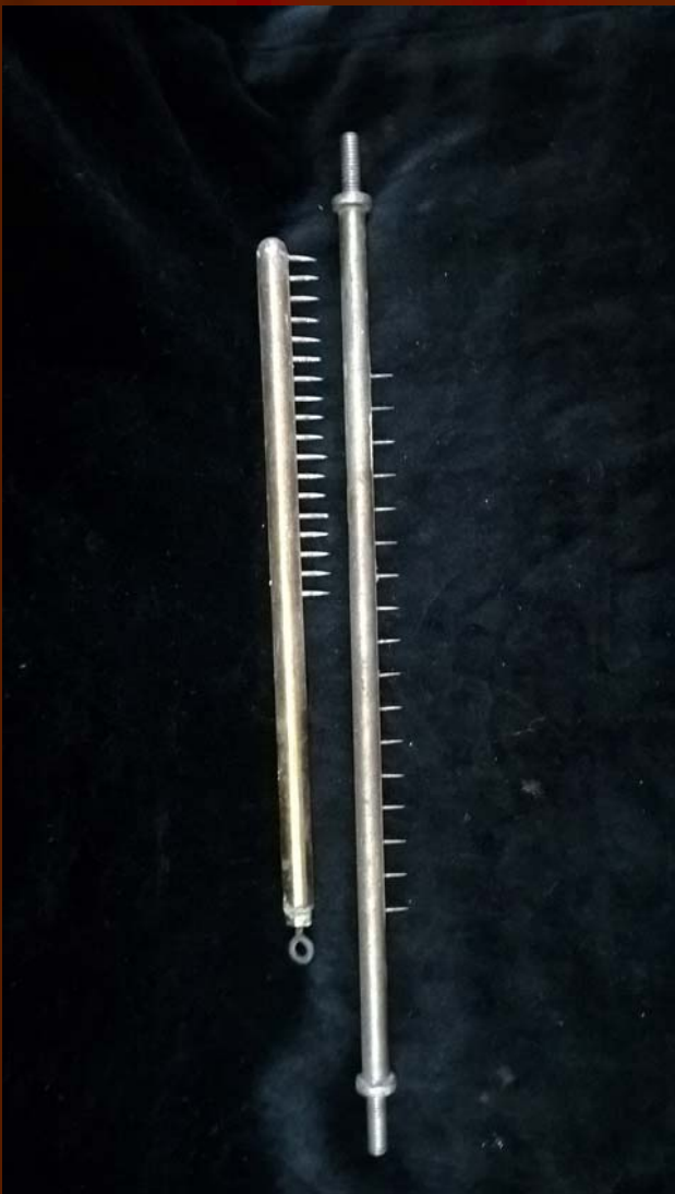
Прилади для створення пружних хвиль у рідині.
