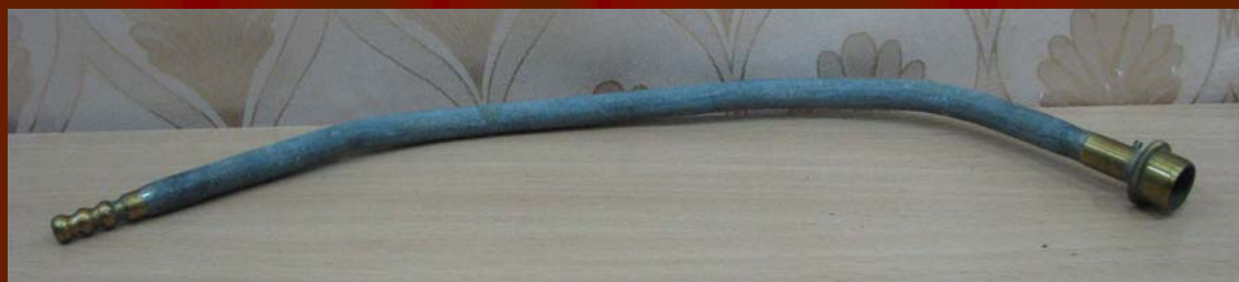
Свинцева трубка для вакуумного насоса. Трубка надана проф. Бадіяном Є.Ю.
