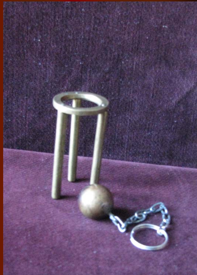
Прилад для демонстрації явища теплового розширення твердих тіл.
