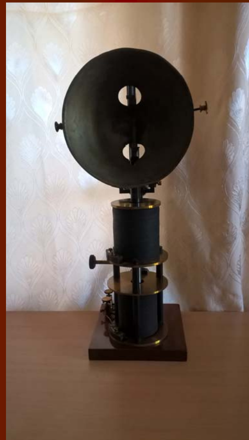
Настільна дугова лампа з автоматичним регулюванням відстаней між електродами з використанням електромагнітів.
