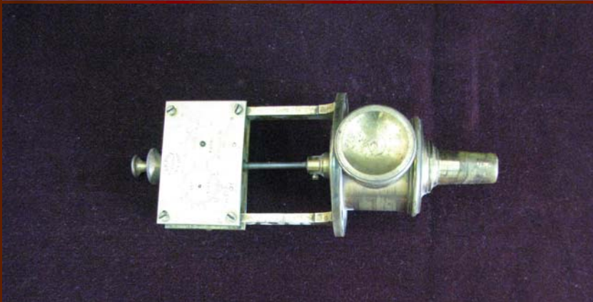
Сирена Каньяр-Латура з лічильним механізмом.
