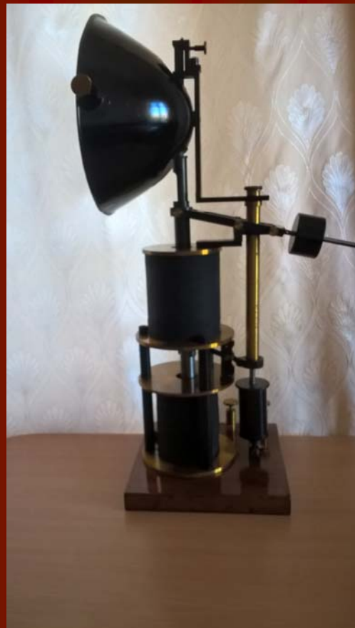
Настільна дугова лампа з автоматичним регулюванням відстаней між електродами з використанням електромагнітів.
