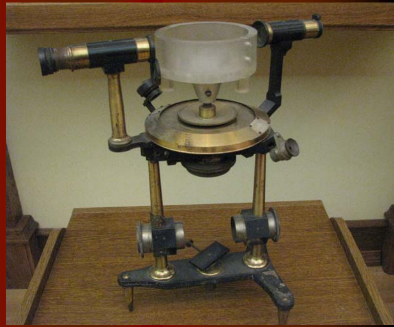
Прилад для визначення показників заломлення рідин.
