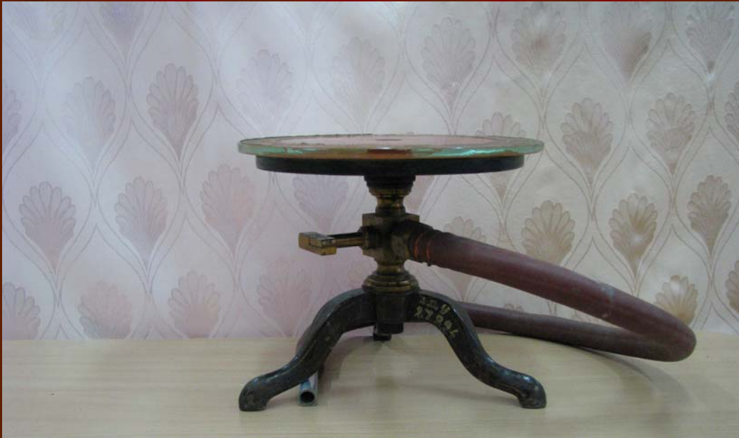
Пристрій для відкачування повітря із посудини (повітряний насос).
