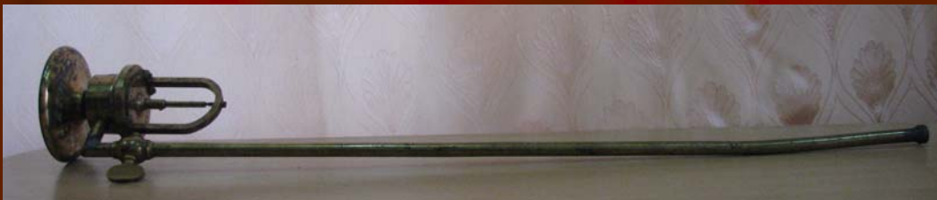
Сирена Каньяр-Латура з лічильним механізмом.
