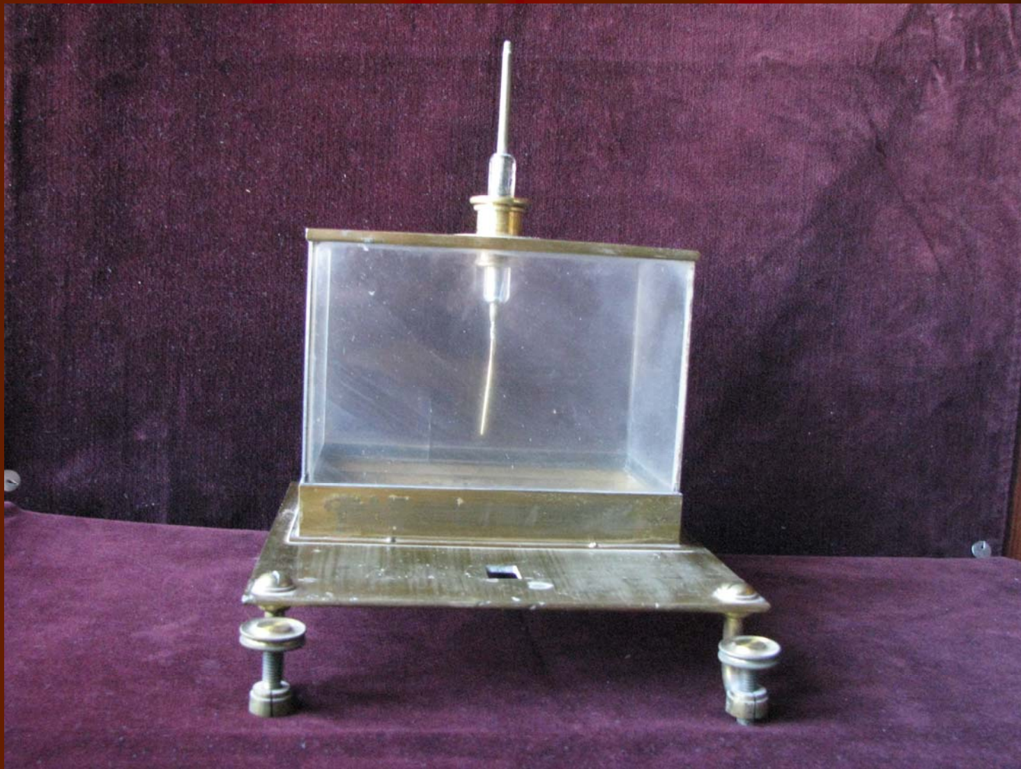
Прилад для демонстрації явища заломлення світла в рідинах.
