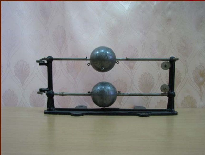
Прилади для демонстрації досліду Генрі Кавендіша.
