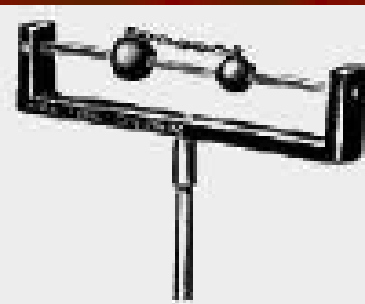
Прилади для демонстрації дії відцентрової сили інерції.
