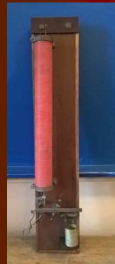
Прилад для утворення стоячих хвиль на шнурі.
