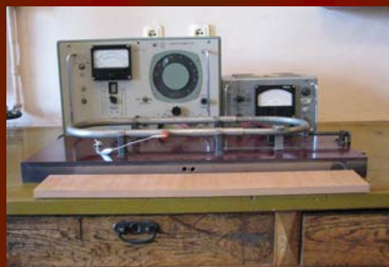
Прилад для дослідження інтерференції звукових хвиль.
