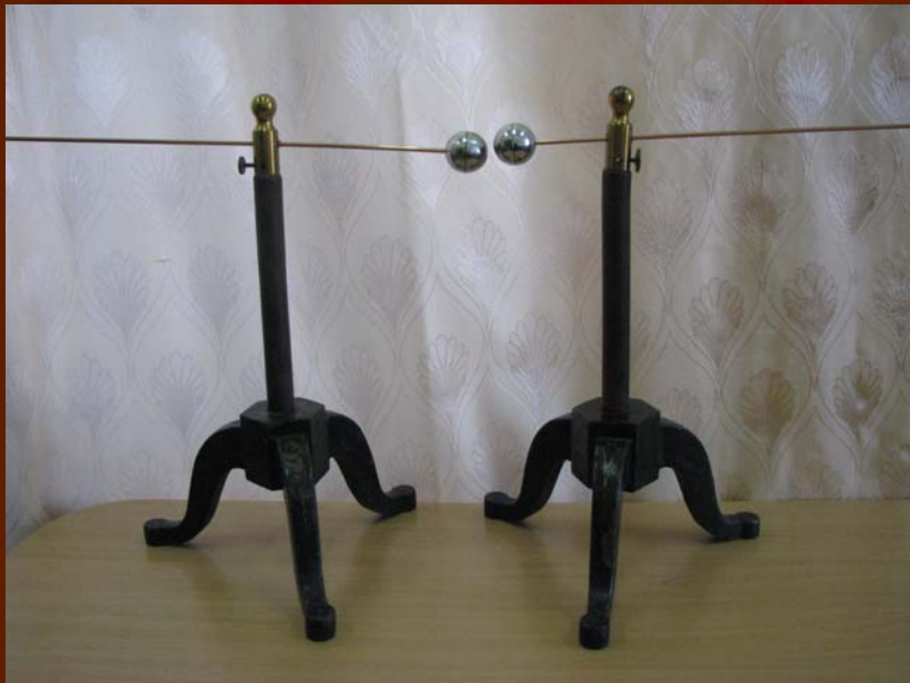
Прилади для демонстрації досліду Генріха Герца.
