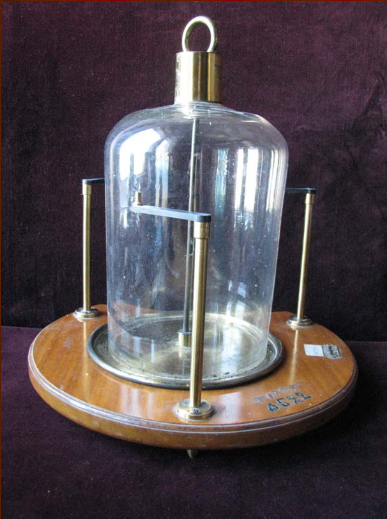
Прилад для показу демонстрацій з електростатики.
