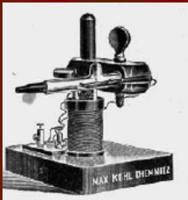
Прилад для дослідження електричних розрядів у газах.
