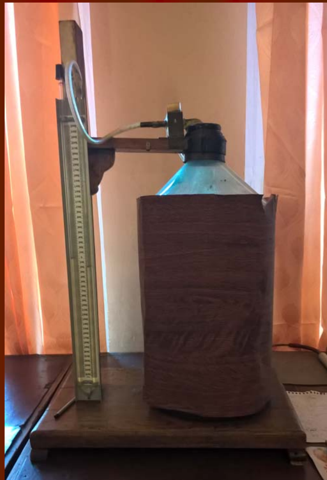
Лабораторний прилад для визначення показника Пуассона за методом Клемана і Дезорма.
