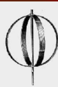
Прилади для демонстрації дії відцентрової сили інерції.
