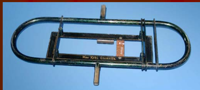
Прилад для дослідження інтерференції звукових хвиль.
