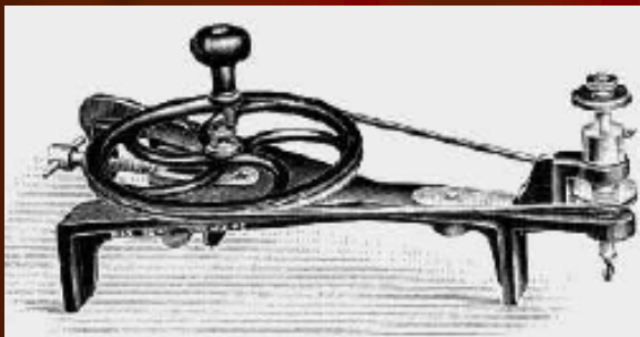
Прилади для демонстрації дії відцентрової сили інерції.
