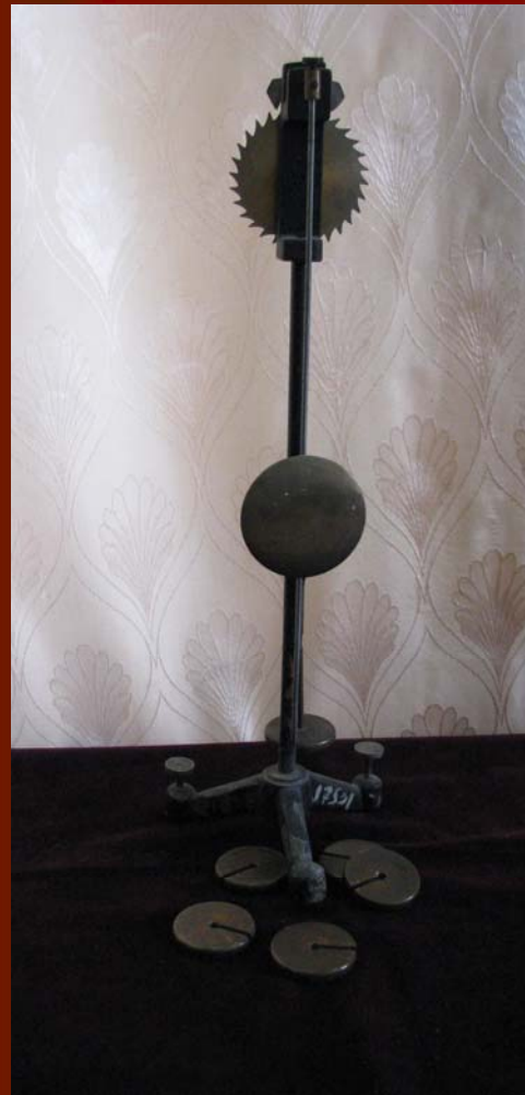
Прилад для демонстрації принципу дії анкерного механізму.
