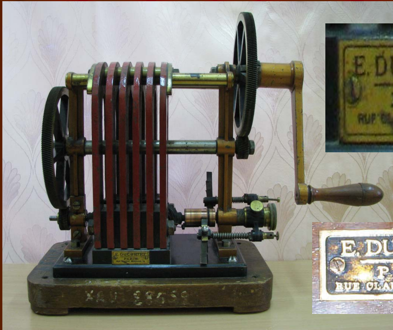
«Ручна динамомашина» – пристрій для отримання електричного струму Ежена Дюкрете.
