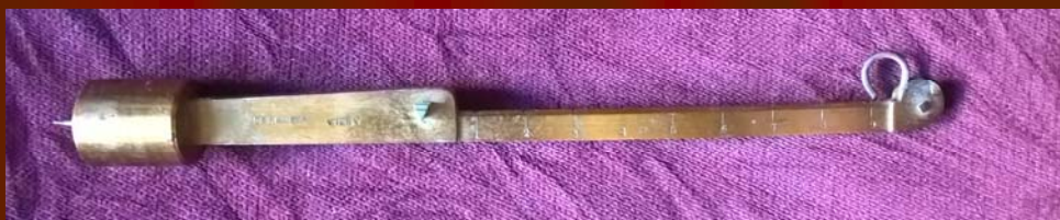
Деталі гідростатичних терез Георга Вільгельма Вестфала.
