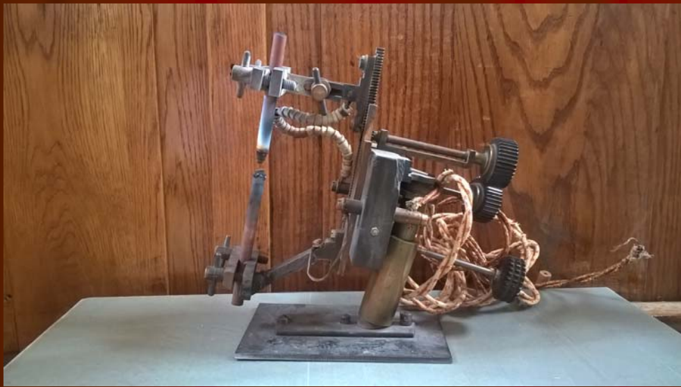
Настільна дугова лампа для проєкційного ліхтаря фірми «E. Leybold's Nachfolger», оснащено дуговою лампою з ручним регулюванням відстаней між електродами.
