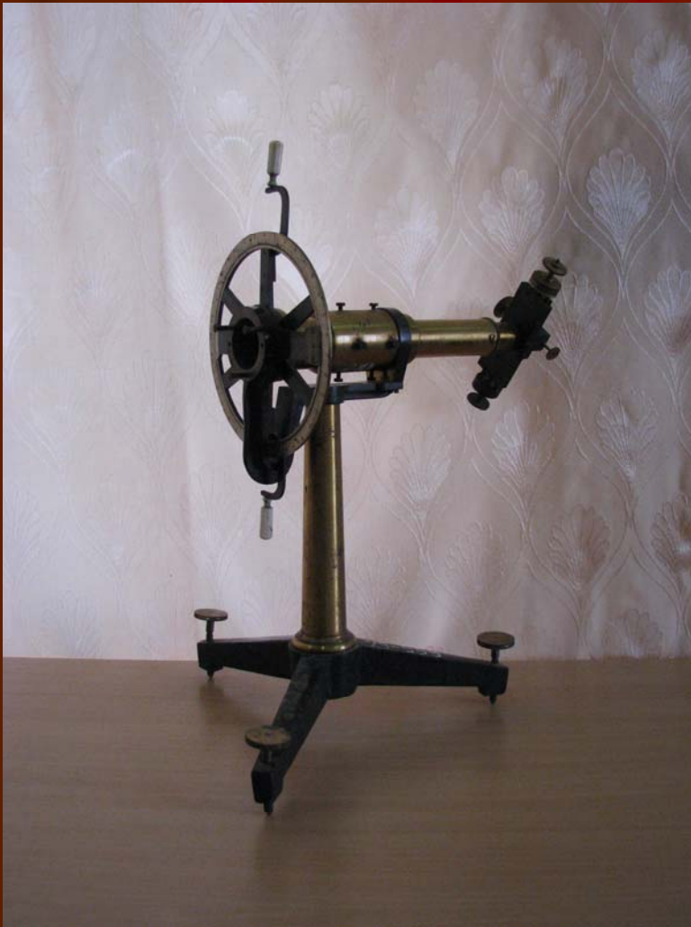
Прилад Зільбермана для дослідження законів заломлення світла.
