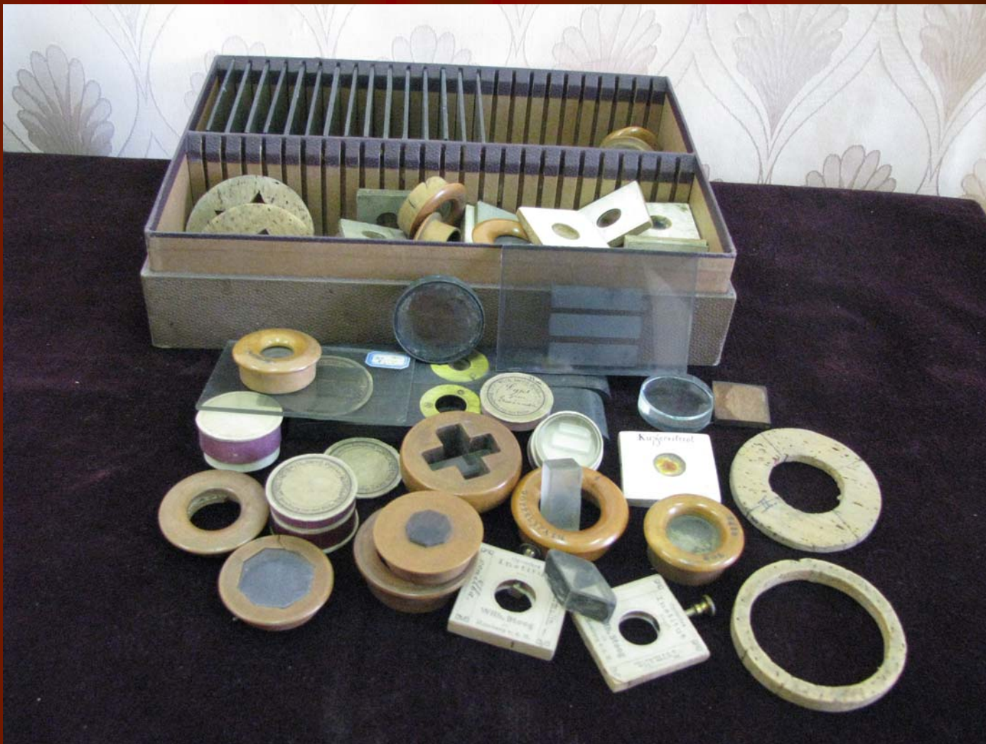
Обладнання до полярископа Жуля Дюбоска.
