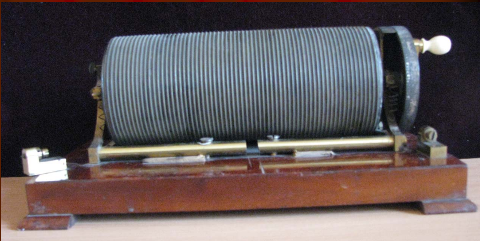
Прилад для вимірювання електричного опору (місток Кольрауша).
